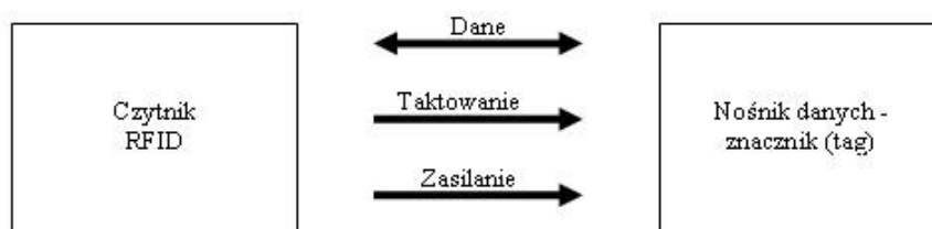
Rys. 17. Schemat działania systemu RFID Źródło: (Logistica 2016)
