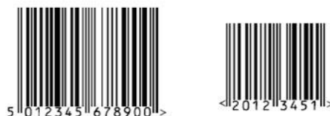
Rys. 15. Przykładowe kod kreskowe EAN-13 i EAN-8 Źródło: ( http://www.portalfid.pl )
